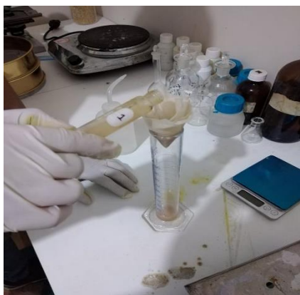
Figura 6. Filtrado de las muestras
