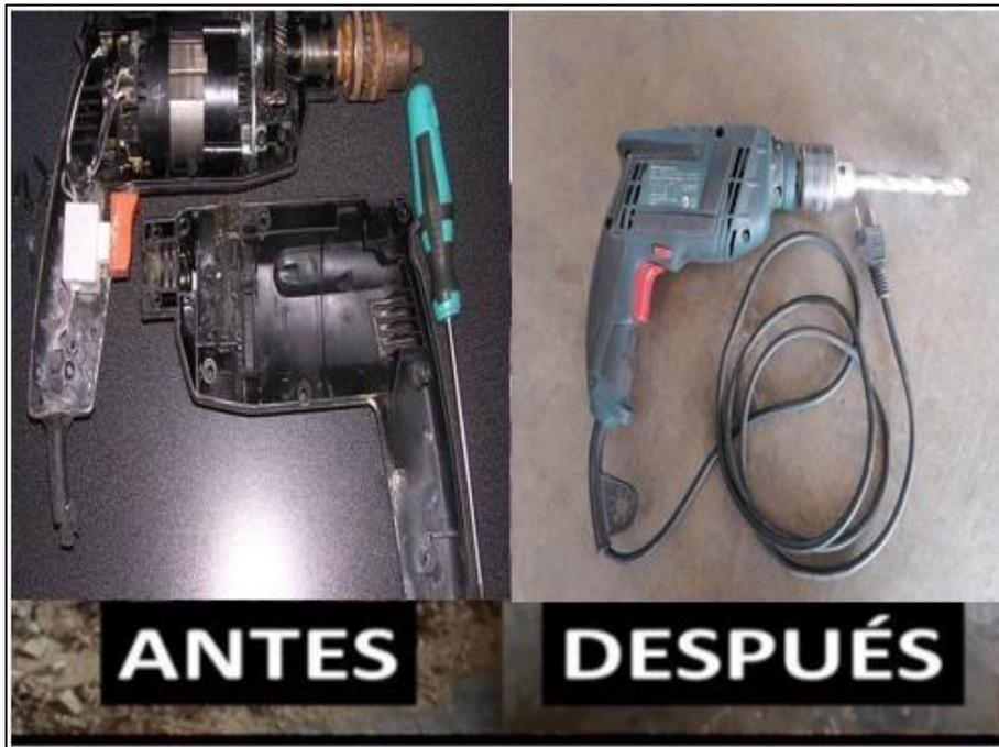
Figura 27. Limpieza y mantenimiento al taladro percutor – Bosch.
