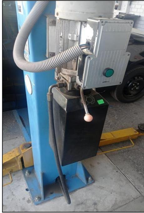
*Figura 15.* Revisión de jebes de apoyo y fuga de aceite del reservorio del elevador.
