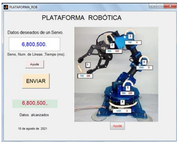
**Figura 7.** Interfaz gráfica en Matlab para la plataforma robótica. Se puede apreciar el cuadro denominado: Datos deseados de un servo con números azules. Es para la captura de los valores de las variables cinemáticas que
