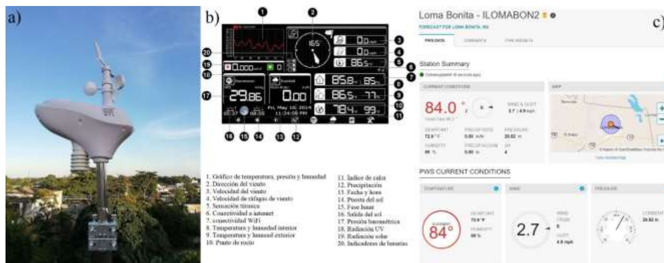
Figura 2. EMP (a) y registros de variables e indicadores atmosféricos en tiempo real (b). La imagen “c” es una captura de pantalla de la página web que alberga la información (temperatura, velocidad, presión y precipitación en °F, millas, mmHg y pulgadas respectivamente).
