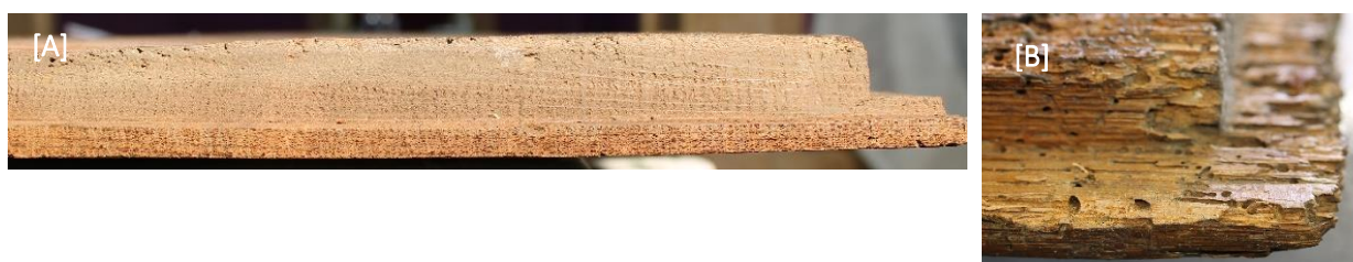
Figure 43. Examples of bevelled edges of oak boards in: [A] Cristo envia S. Tiago e S. João em missão apostólica (22 Pint); and [B] Conversão de Hermógenes (20 Pint).
