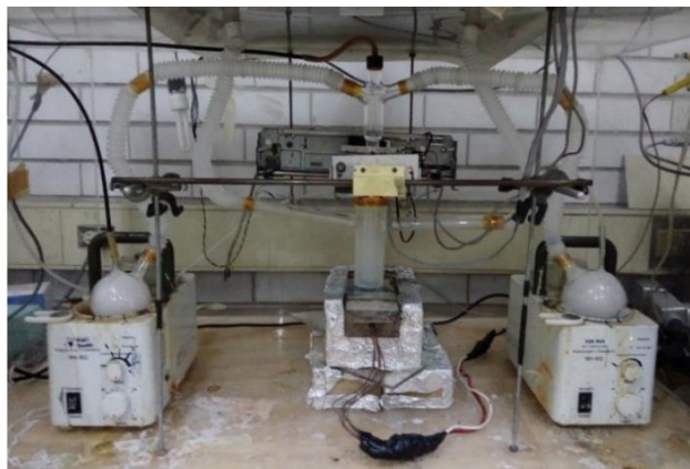
Figura 4. Equipo de deposición por spray ultrasónico empleado para obtener las películas delgadas de Zn-BDC.
