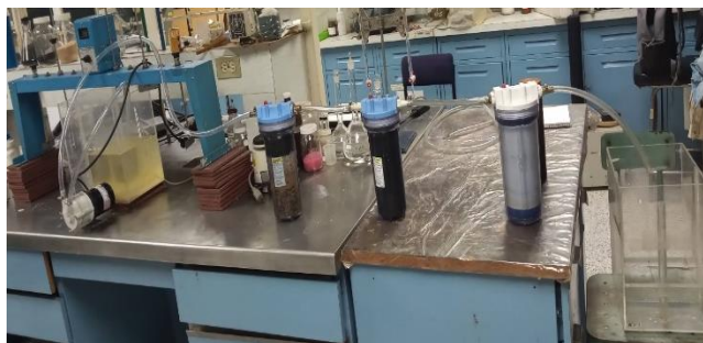
Figura 2. Tren de tratamiento de agua convencional.
