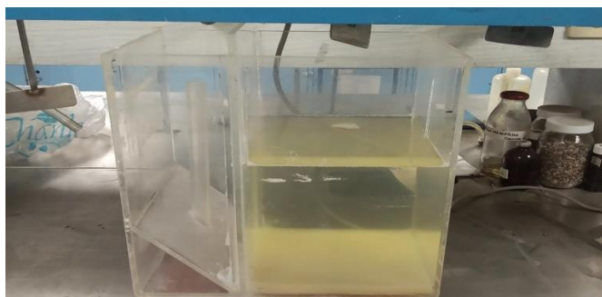
Figura 3. Sedimentación en tratamiento convencional.
