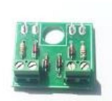
Figura 5.23 – Placa de proteção dos IGBT.
