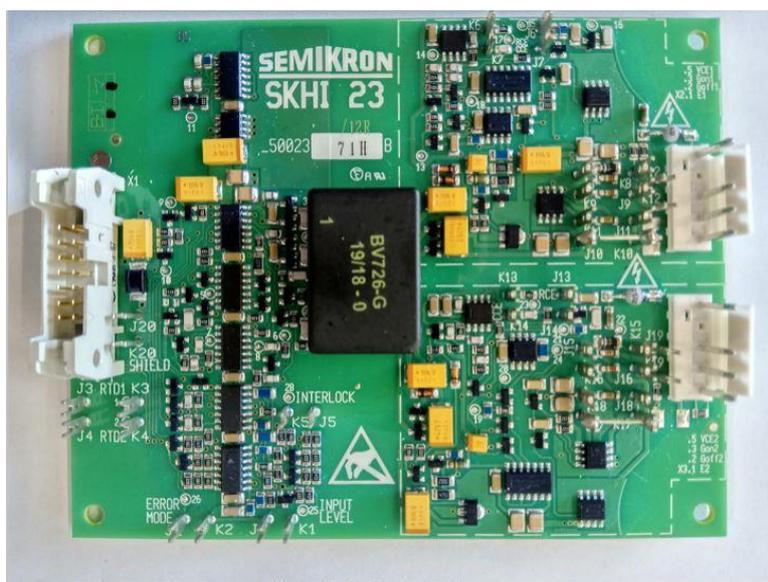
Figura 5.22 – Placa de *driver* dos IGBT.
