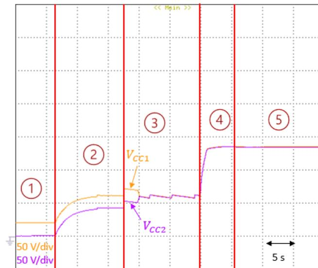
Figura 6.14 - Resultados experimentais da regulação e equilíbrio da tensão no barramento CC.
