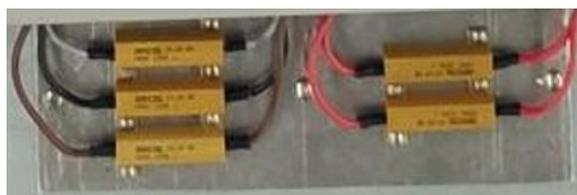
Figura 5.10 – Resistências de pré-carga.
