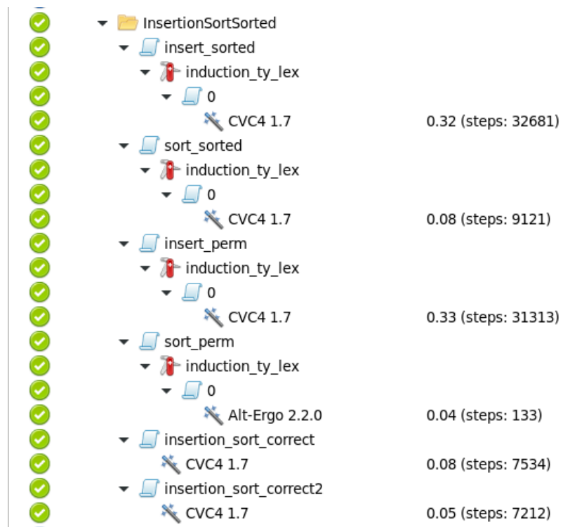
Figura 11: Apresentação no IDE do Why3 da prova completa do algoritmo insertion sort na lógica.
