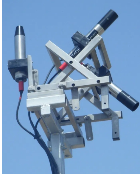
Figura 4.11: Imagen de unos radiómetros hiper-espectrales colocados en Doñana para realizar la calibración de los datos de teledetección.
