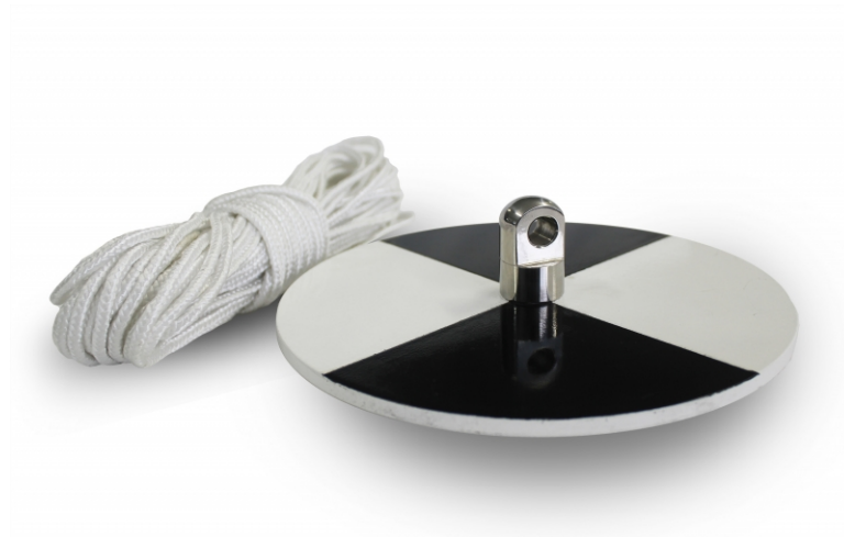
Figura 2.5: Disco Secchi. Objeto utilizado para estimar la turbidez o la transparencia del agua.
