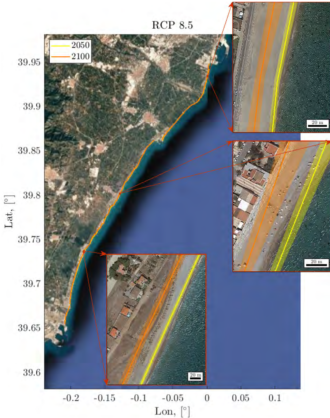
Figura 0.17: Líneas de costa en la temporada estival (mayo-septiembre) en 2050 y 2100 en Torre (panel superior), Moncófar (panel intermedio) y Almenara (panel inferior). Las líneas sólidas representan la mediana y las bandas se corresponden con la banda de confianza del 50% de las 15 combinaciones de RCM y trayectorias de ANMM para el RCP8.5.
