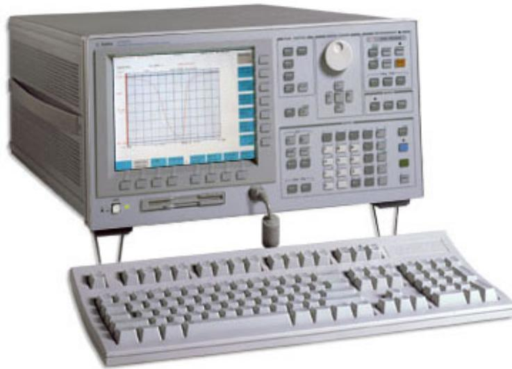
Figure 4.2 Agilent 4155C semiconductor parameter analyzer
