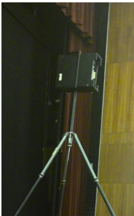
Figura 4.10 – Equipamentos de RASTI Brüel & Kjær, emissor modelo 4425 (esquerda) e recetor modelo 4419 (direita) [Fotos do autor]
