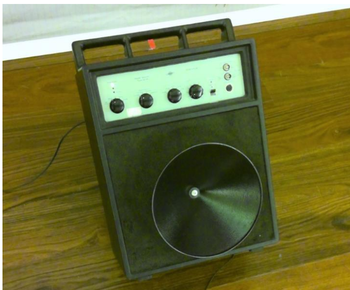
Figura 4.9 – Fonte sonora Brüel & Kjær, modelo 4224 (esquerda) e Sonómetro Brüel & Kjær, modelo 2260 sobre tripé portátil Brüel & Kjær, modelo UA0049 [Foto do autor]
