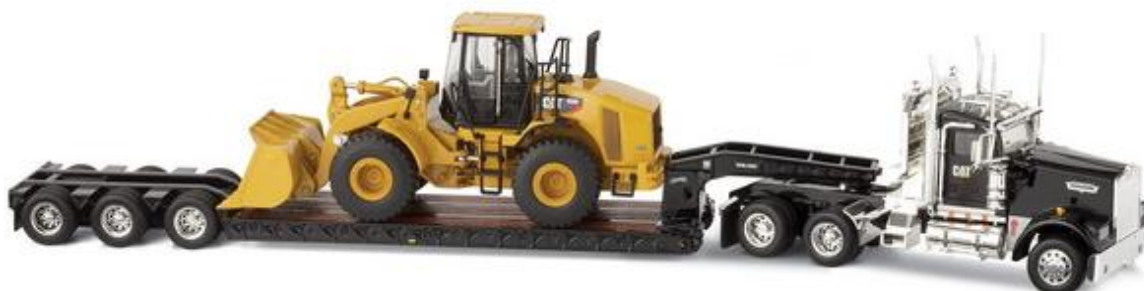
Fig. 219. Camión remolcando carretón, que está cargado con una cargadora frontal
