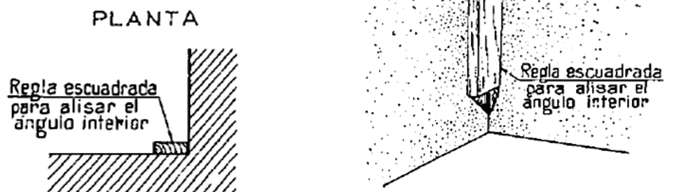
Fig. 157. Revocado de muros que forman esquina interior
