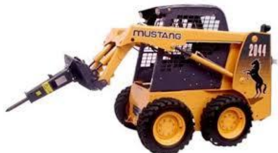
Fig. 221. Minicargadora con accesorio de martillo hidráulico
