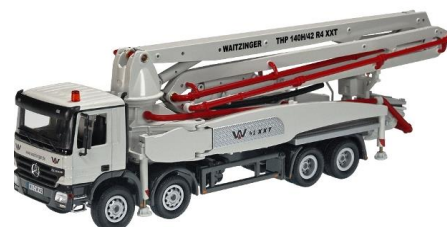
Fig. 184. Bomba de mástil distribuidor
