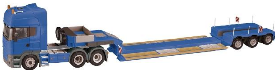
Fig. 218. Camión remolcando carretón descargado
