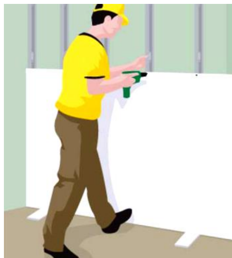
Fig. 86. Colocación de placa de yeso
