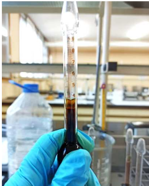
Figura 4. Lectura del contenido de grasa en la escala del butirómetro.
