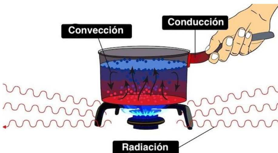
Ilustración 7. La conducción se transmite a lo largo del material, la convección por el vapor y la radiación calentando objetos próximos. Fuente: https://concepto.de/transferencia-de-calor/
