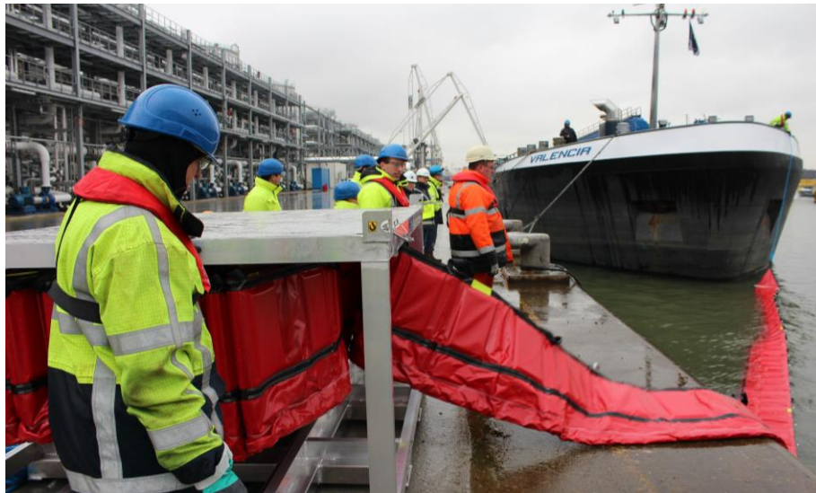
Ilustración 41. Ejemplo de barrera de contención FOB a bordo y su soporte de estiba. Fuente: https://www.lamor.com/es/equipo/foam-filled-oil-boom
