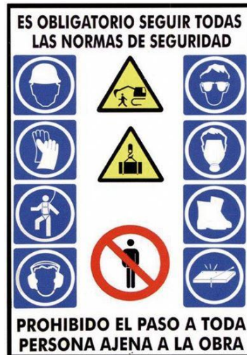
Figura 8.1. Cartel en entrada de obra.
