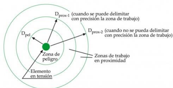
Figura 8.6. Zona de proximidad de riesgo eléctrico.
