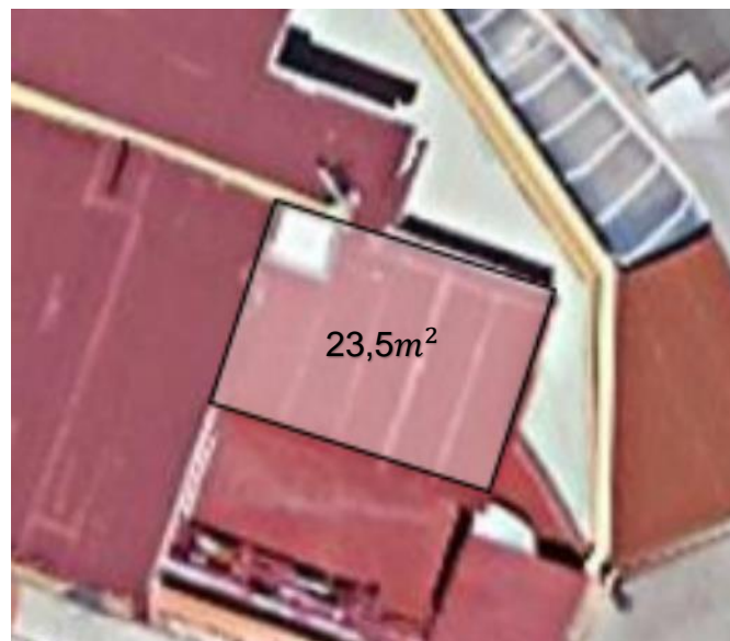
Figura 4. Área superficie instalación FV.
