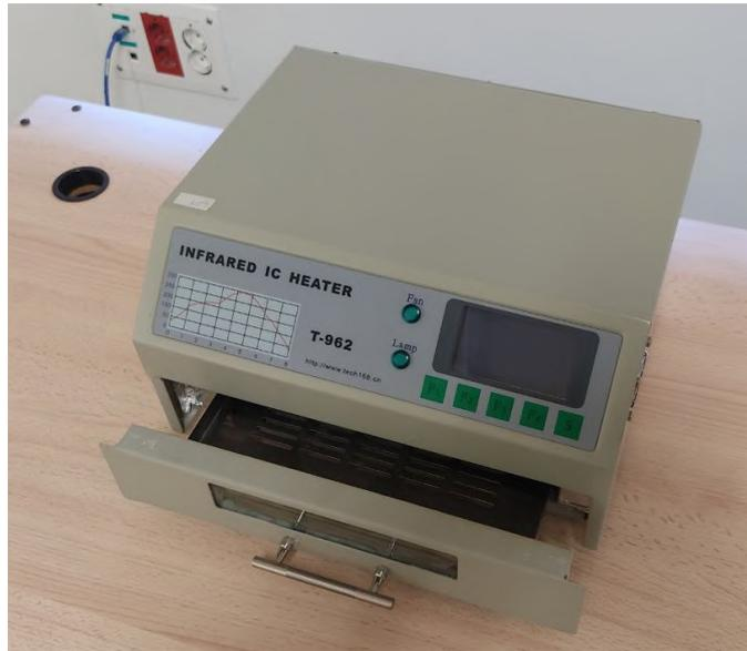
Figura 2.2: Horno de soldadura T962.
