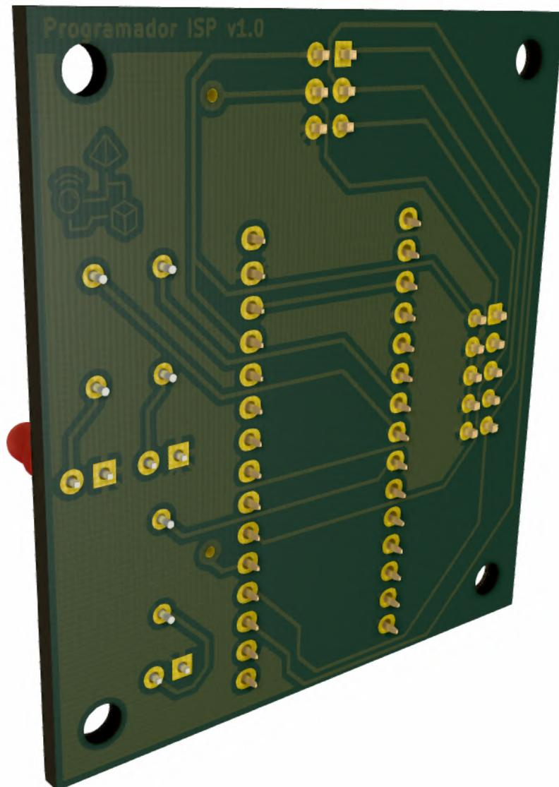
Figura K.8: Modelo 3D del Programador ISP. Vista inferior.
