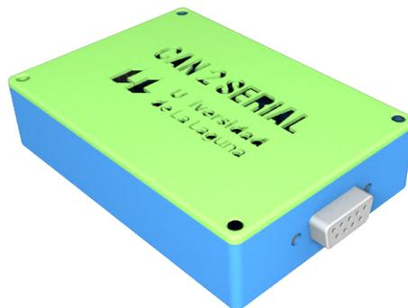
Figura 3.6: Diseño 3D de la interfaz de comunicación CAN2Serial.
