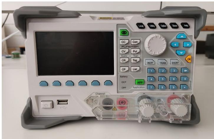
Figura 2.5: Carga electrónica Rigol DL3031A.
