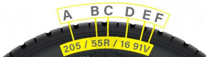
**Figura 4.45** Significado de la nomenclatura de neumáticos
