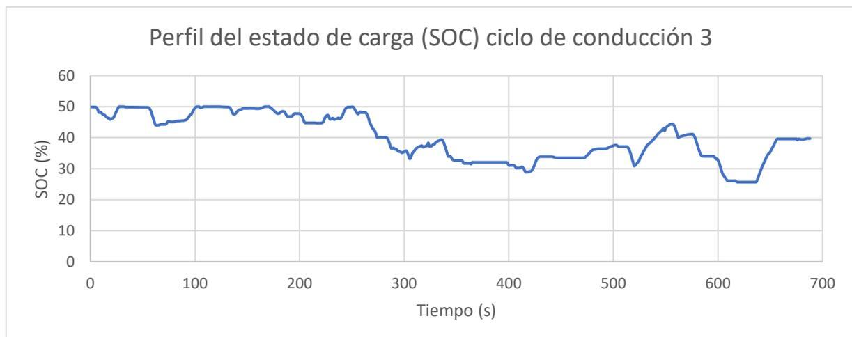
**Figura 5.31** Perfil del estado de carga medido ciclo de conducción 3 Toyota C-HR
