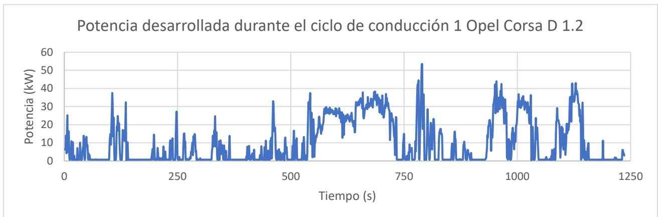
**Figura 5.7** Potencia desarrollada durante el ciclo de conducción 1 Opel Corsa D 1.2
