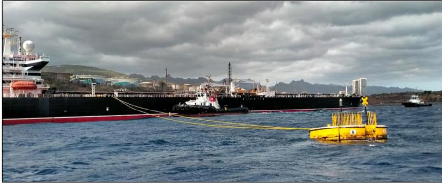
Ilustración 58. Cabos encapillados en boya 6.
