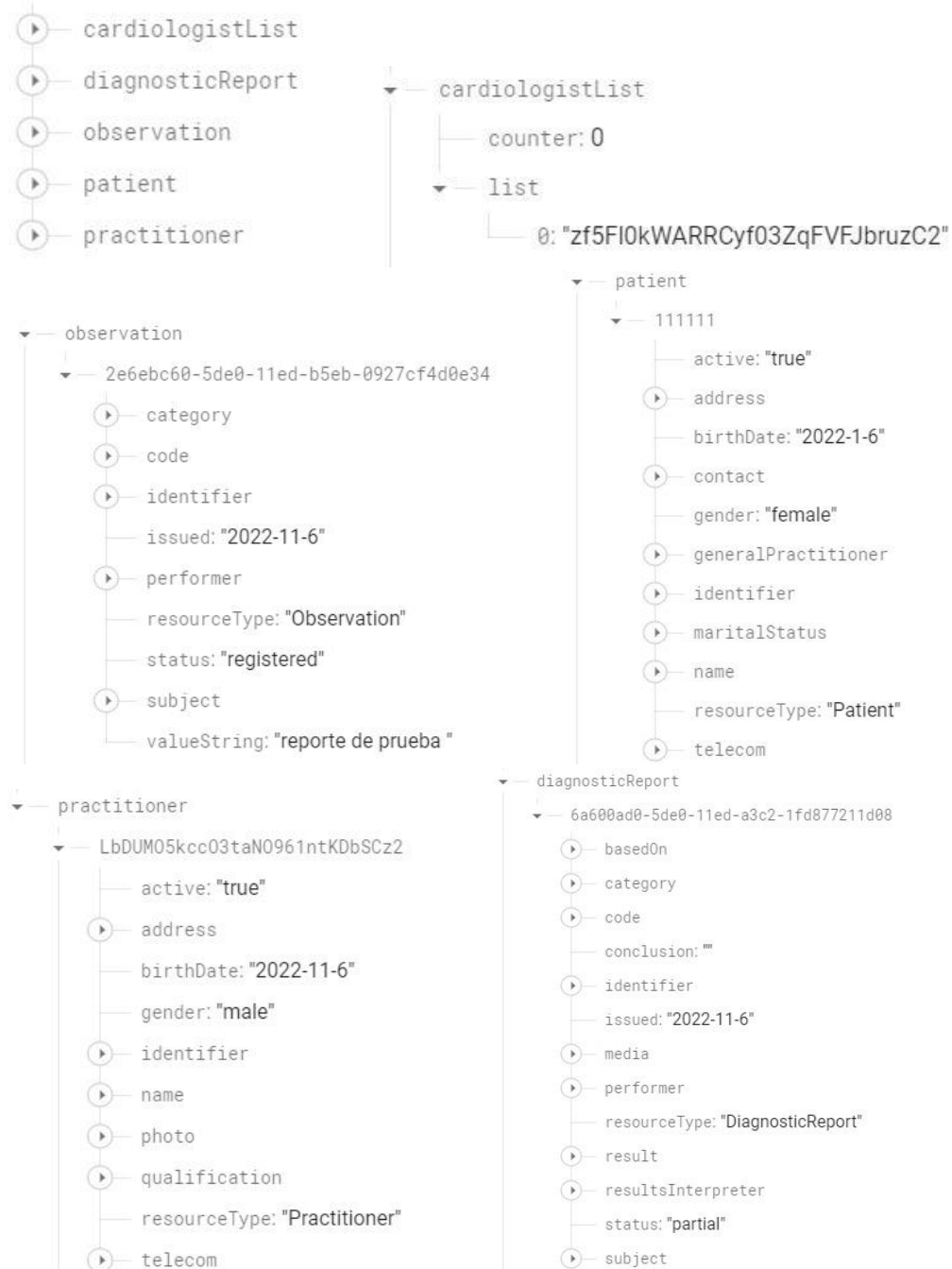
Ilustración 24 Estructura de la Base de Datos-1
