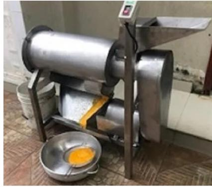
**Figura 20.** Despulpadora semiindustrial
