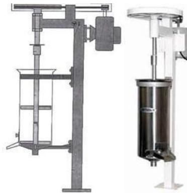
**Figura 10.** Despulpadora vertical [1].
