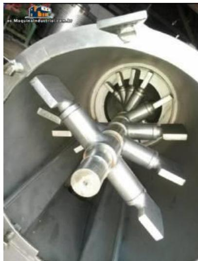
**Figura 9.** Paletas internas de despulpadora [7].
