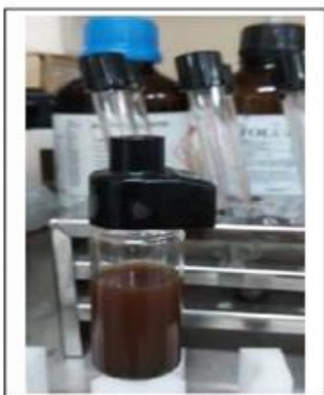
Fig. 8. Celda conteniendo la mezcla de fuel oil con el residuo de brea después de la provocación de la floculación forzada con n -heptano para la medición del TSI.
