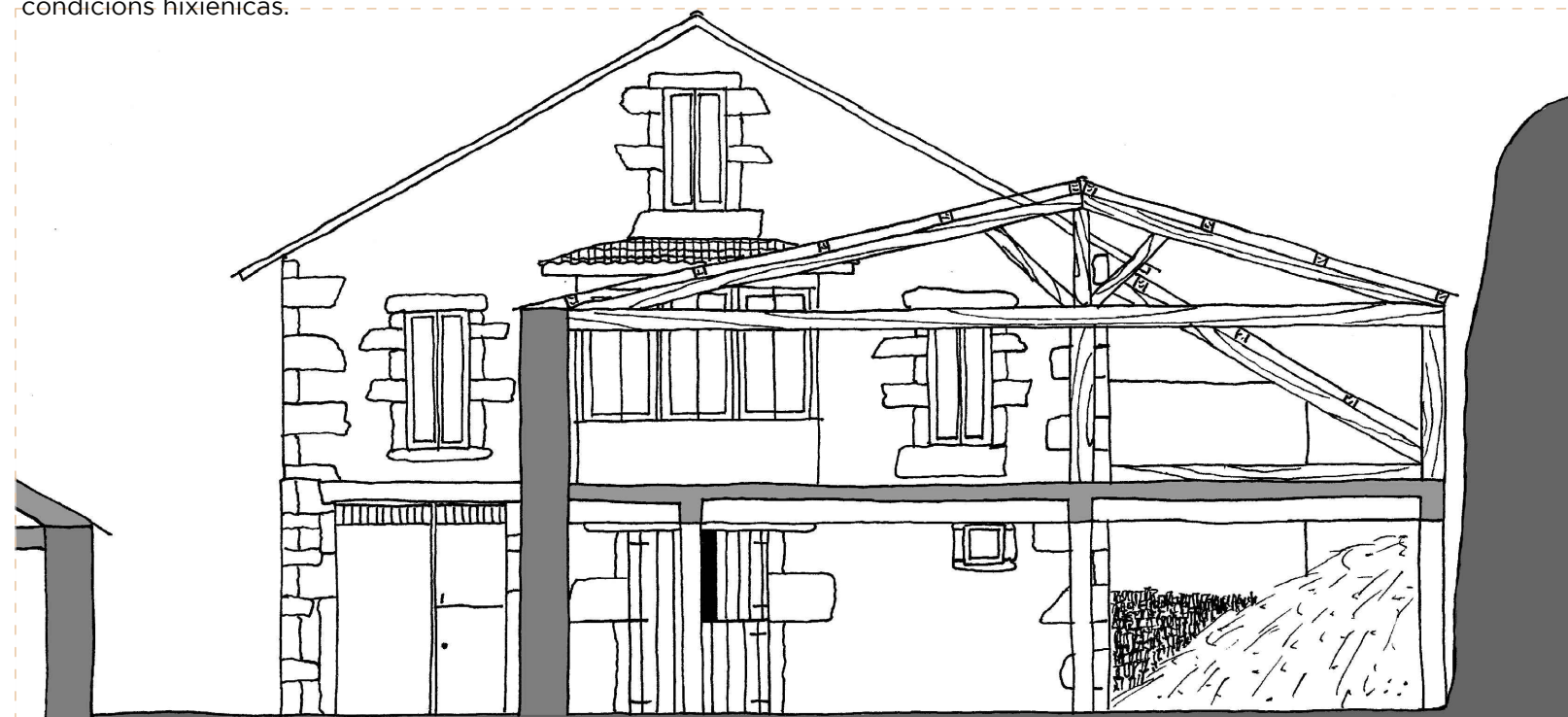
_Fig.89. Alzado da edificación singular da _Fig.90, da aldea de Roo, na época do tractor (1970). Elaboración propia. Escala: 1/100.
