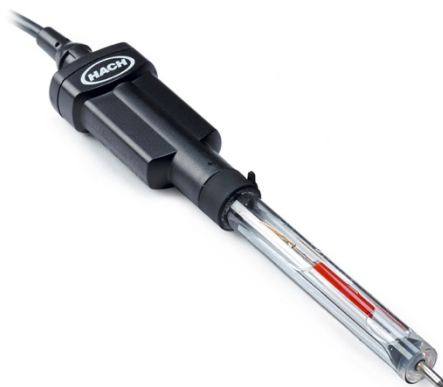
Figura 3.2- Eléctrodo combinado de prata com pino poroso utilizado nas medições
