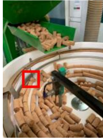
figura 5-12 Encravesamentos dos canais to tambor
