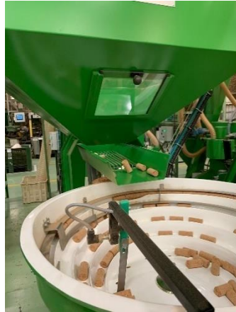
figura 5-11 Falta de alimentação do mini silo a seguir à ponçadeira
