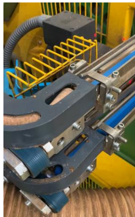
figura 5-13 Encravesamento de rolhas nos cantos dos canais de alimentação (A-Antes; B-Depois)
