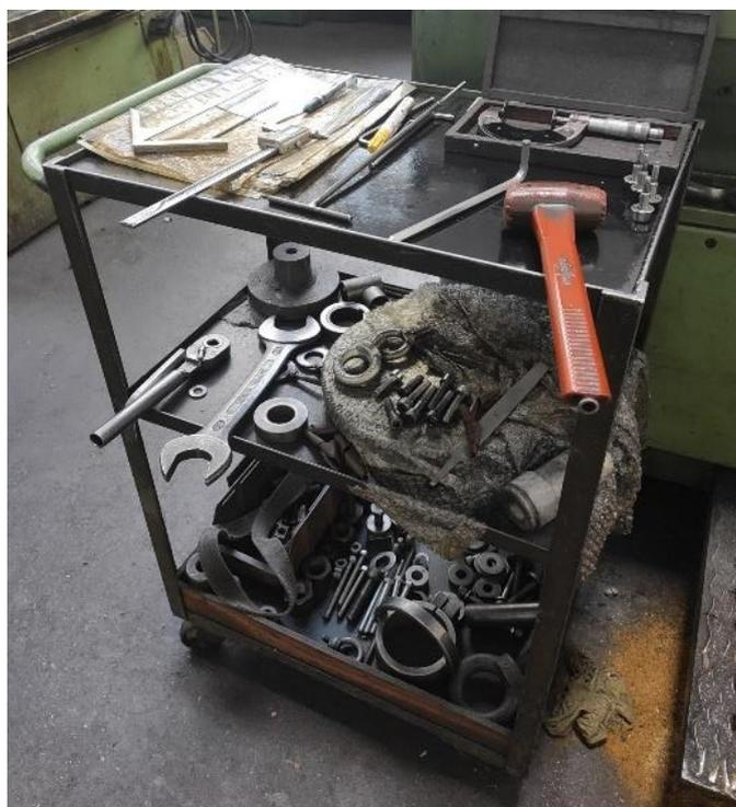
Figura 3.13: Exemplos de postos de trabalho com excesso de ferramentas.
