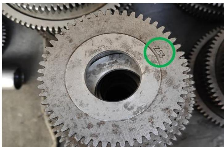
Figura 4.20: Exemplar de uma roda dentada rotulada da fábrica.
