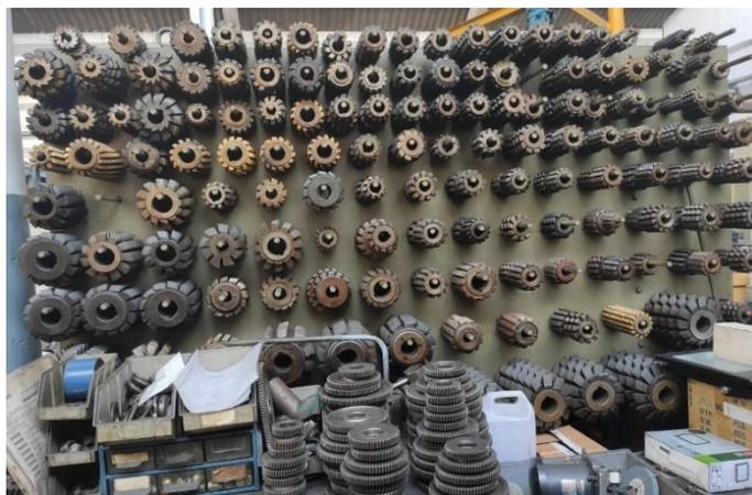
Figura 3.19: Exemplo de fresas-mãe armazenadas por tipo.
