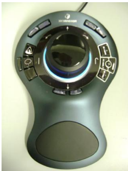
Figura 5. Consola do sistema V-Drive® para controle remoto do cateter circular Lasso® utilizando o braço robótico na mesa do doente.
