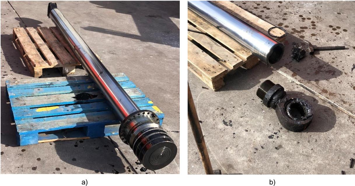
Figura 6.5 – Desmontagem da Parte Móvel do Macaco Hidráulico a) Êmbolo e b) Orelha do Êmbolo Removida
