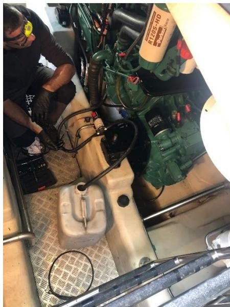
Figura 6.10 - Remoção de Óleo do Motor
