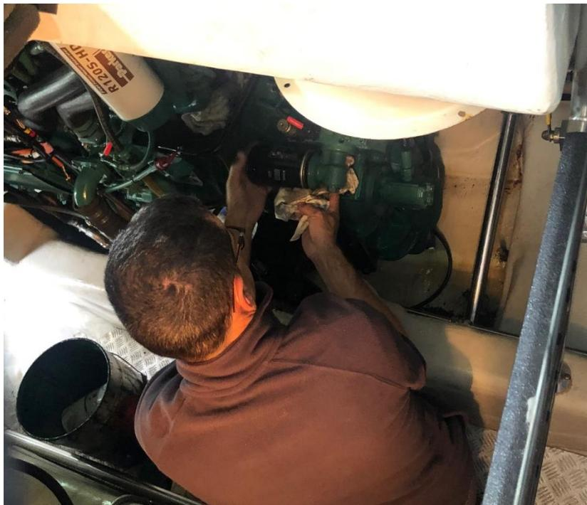
Figura 6.13 - Substituição do Filtro de Óleo da Caixa
