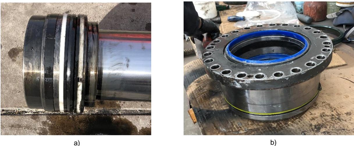
Figura 6.6 – Substituição de Vedantes a) na Parte Inferior do Êmbolo e b) Cabeça do Êmbolo
