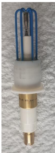
Figura 18 – Eléctrodo onde passa a alta tensão
