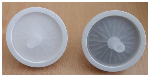
Figura 56 – Filtro novo (esquerda) e filtro substituído (direita)
