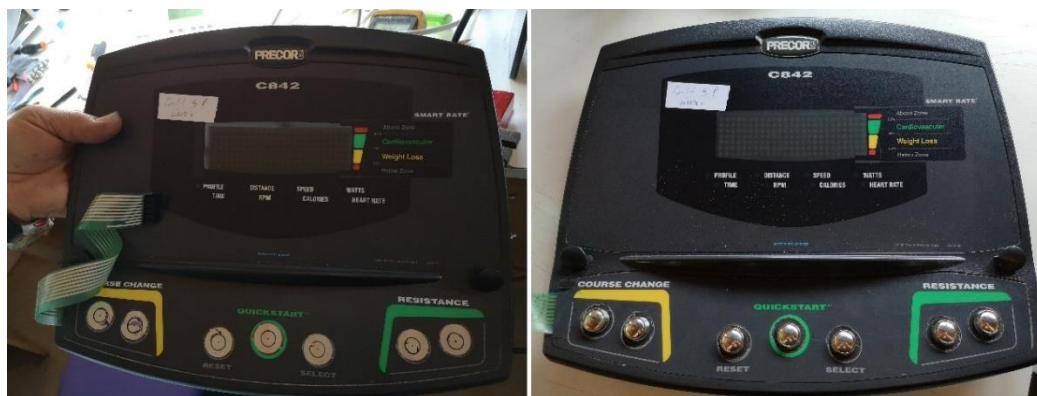
Figura 61 – Painel antes da substituição (esquerda) e painel após aplicação dos botões pulsados (direita)
