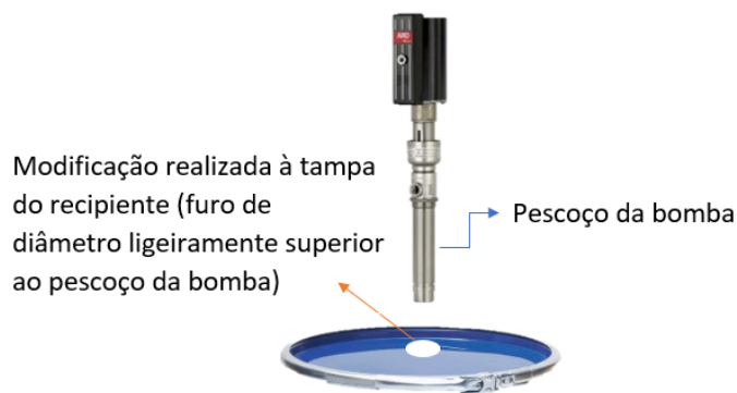
Figura 25 - Modificação efetuada na tampa do reservatório.
