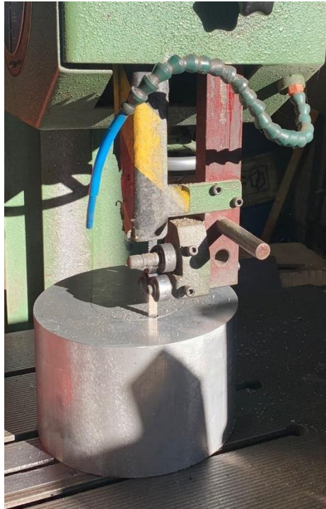
Figura 19 - Abertura de furo para remoção de material interior através de serrote de fita.
