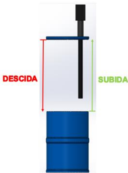
Figura 27 - Esquema da elevação da tampa e bomba hidráulica acopladas para substituição do reservatório.
