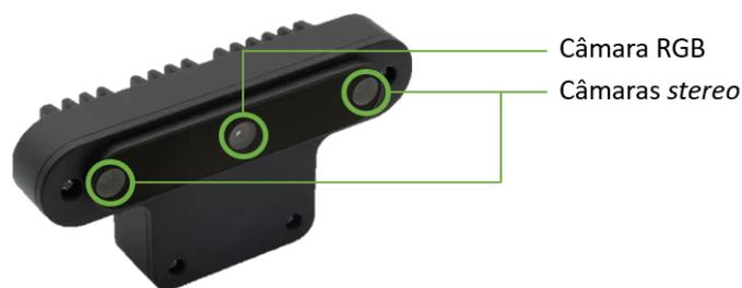
Figura 5.32: Dispositivo OAK-D e as suas diferentes câmaras.
