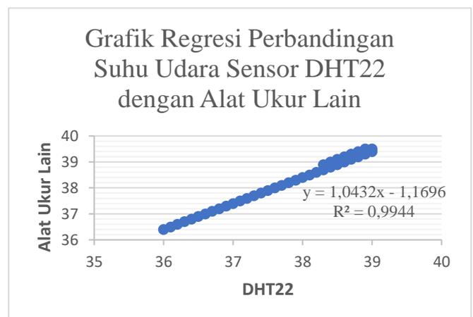
Gambar 6. Kurva Regresi Linear Hasil Pengukuran Suhu
