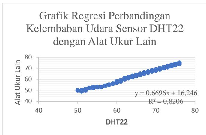
Gambar 8. Kurva Regresi Linear Hasil Pengukuran Kelembaban Udara
