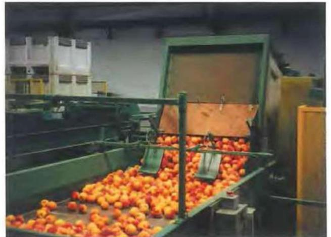
Foto 6. Volcado automático de palots en la línea de empaquetado
