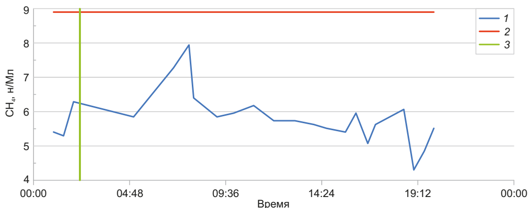
Рис. 6. Диаграмма изменения концентраций метана до и после землетрясения 22.10.2017 г, в 04:38, глубина эпицентра 10 км. 1 – концентрация метана, нМ/л, в поверхностном слое морской воды; 2 – фоновое значение метана, нМ/л; 3 – землетрясение.
