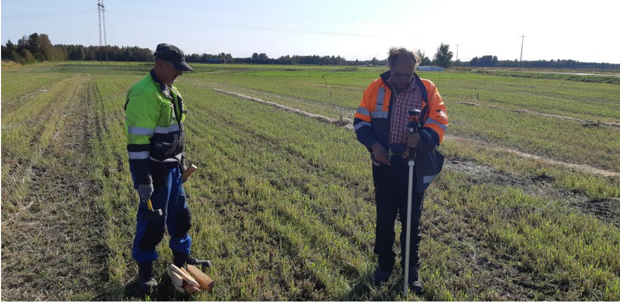
Kuva 41. Humalatarhan tolppien paikkojen merkintä takymetrillä. Kuva: Jarmo Saariniemi, Lappia 3.9.2020.
