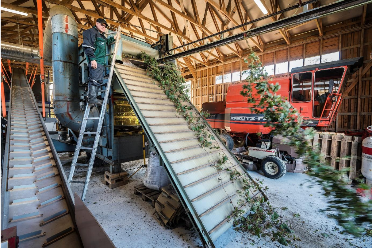
Kuva 14. Katkaistuja humalaköynnöksiä menossa kuljettimella puimuriin, joka irrottaa humalantähkät sivuversoista. Kuva: Johannes Tervo/Maaseudun Tulevaisuus.
