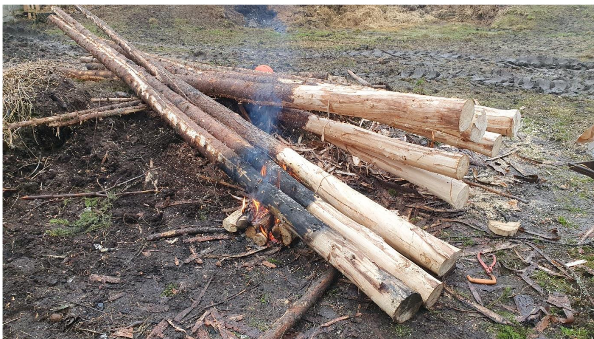
Kuva 22. Itsetehtyjen pylväiden käyttöikää lisää pylväiden maahan uppoavien alaosien polttaminen hiillokselle. Kotimaisista puulajeista kuusi on kestävä valinta. Kuva: Matti Kanabro.
