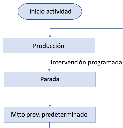
Ilustración 2. Diagrama del proceso de mantenimiento predeterminado. Elaboración propia basada en la definición de la norma UNE 13306.
