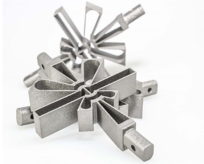
Bild 9: Kaskadierte Festkörpergelenke, gefertigt in einem SLM Verfahren aus Ti6Al4V
