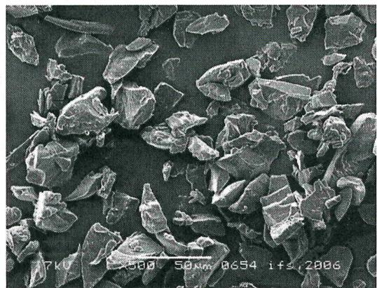
Bild 2 REM-Aufnahme einer 32 µm-Fraktion
