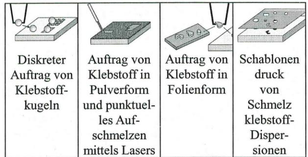
Bild 1 Unterschiedliche Schmelzklebstoffauftragsarten
