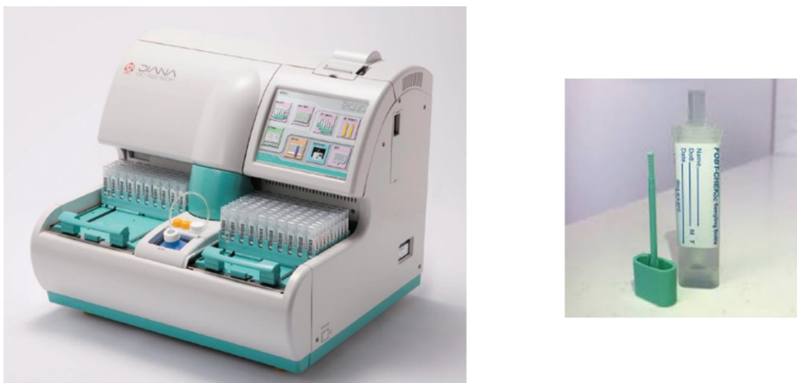
Figura 9. Analizador automático OC-Sensor DIANA para la determinación cuantitativa de sangre oculta en heces (Izquierda) y dispositivo para recoger muestra fecal (Derecha).
