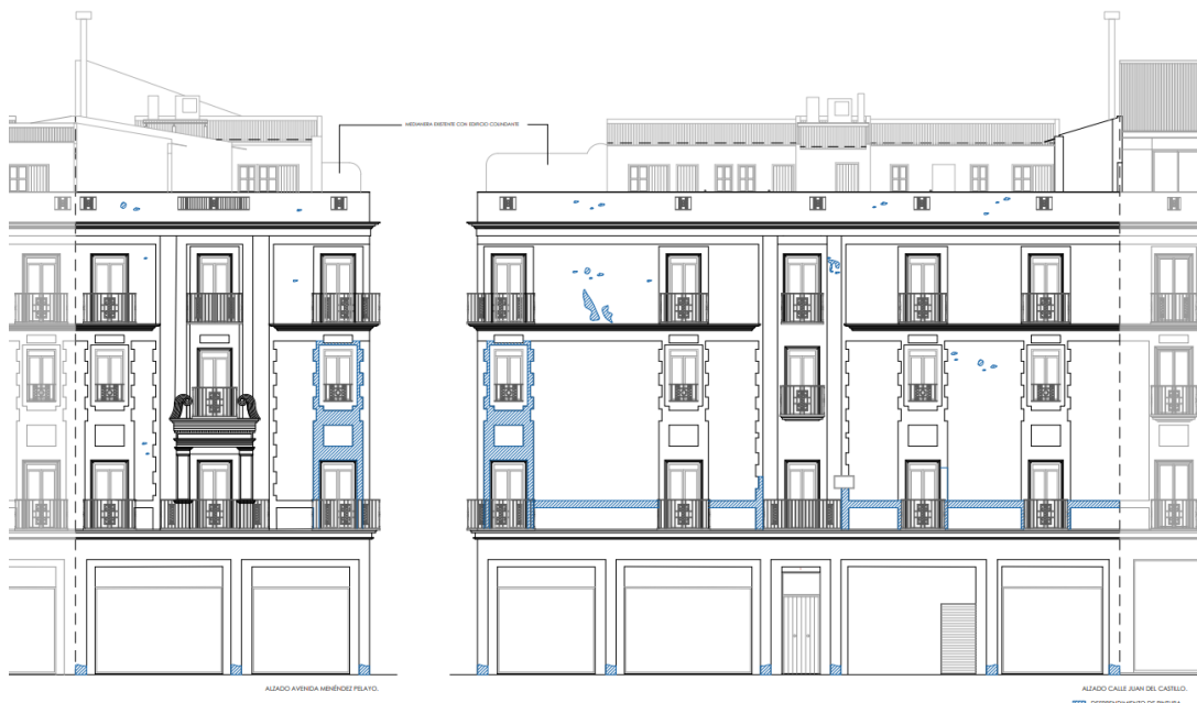
Figura 15: Alzados estado actual de la fachada y sus lesiones. Fuente: Creación propia
