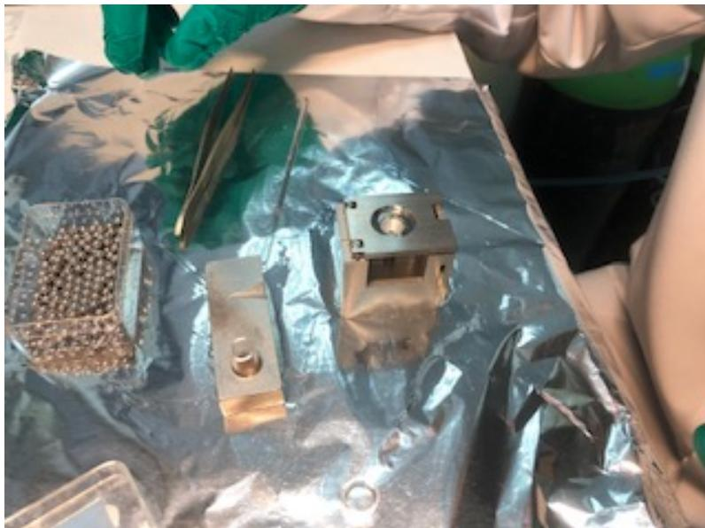
Figura 7: Material para el prensado de los cátodos
