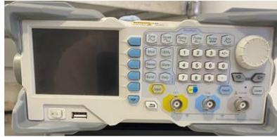
Figura 30. Fotografía del generador de onda utilizado.
