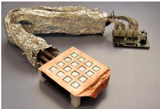
Figura 8. Ejemplo circuito integrado de sensores capacitivos [15]
