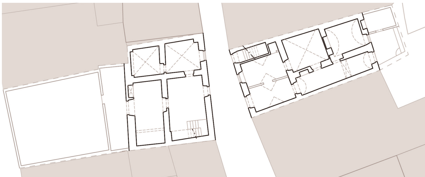
Dos bajos en la calle 1.º de Dezembro. Bóvedas de distintos formatos | plano Ana Rosado
