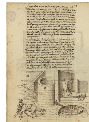
Figura 4.7 Lastanosa, Pedro Juan (1601 -1700?). Funcionamiento de un molino de cubo II. Tomado de "Los veintiún libros de los ingenios y de las máquinas". Tomo 3, pág. 531.
