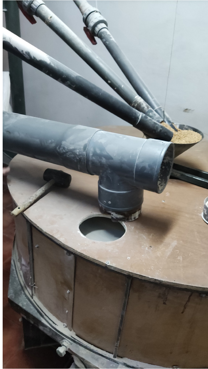
Figura 4.37 Guardapolvere para cubrir las muelas del molino de Escalona (2022). Autora.
