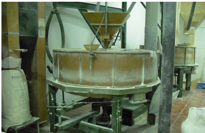
Figura 4.35 Sistema de molturación del molino de Escalona (Segunda mitad del siglo XX). Fotografía proporcionada por Blas Escalona.
