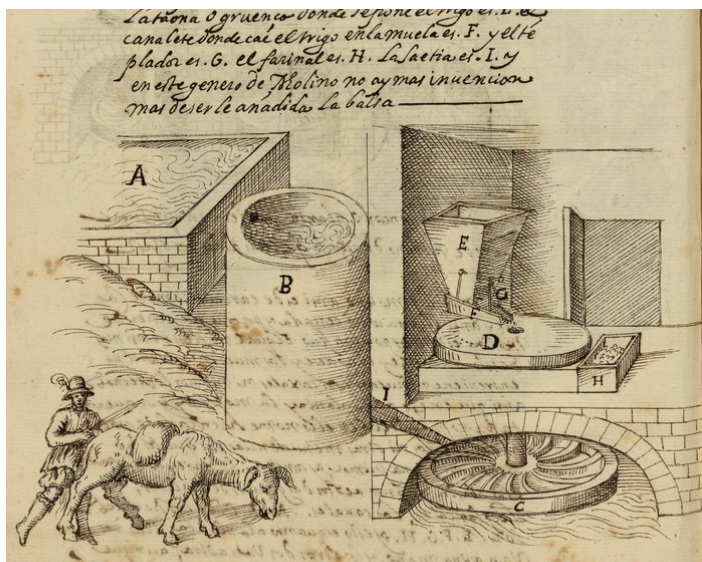
Figura 4.11 Lastanosa, Pedro Juan (1601 -1700?). Detalle del funcionamiento de un molino de cubo II. Tomado de "Los veintiún libros de los ingenios y de las máquinas".
