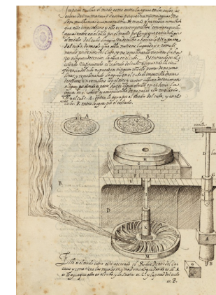
Figura 4.6 Lastanosa, Pedro Juan (1601 -1700?). Funcionamiento de un molino de cubo I. Tomado de "Los veintiún libros de los ingenios y de las máquinas". Tomo 3, pág. 507.
