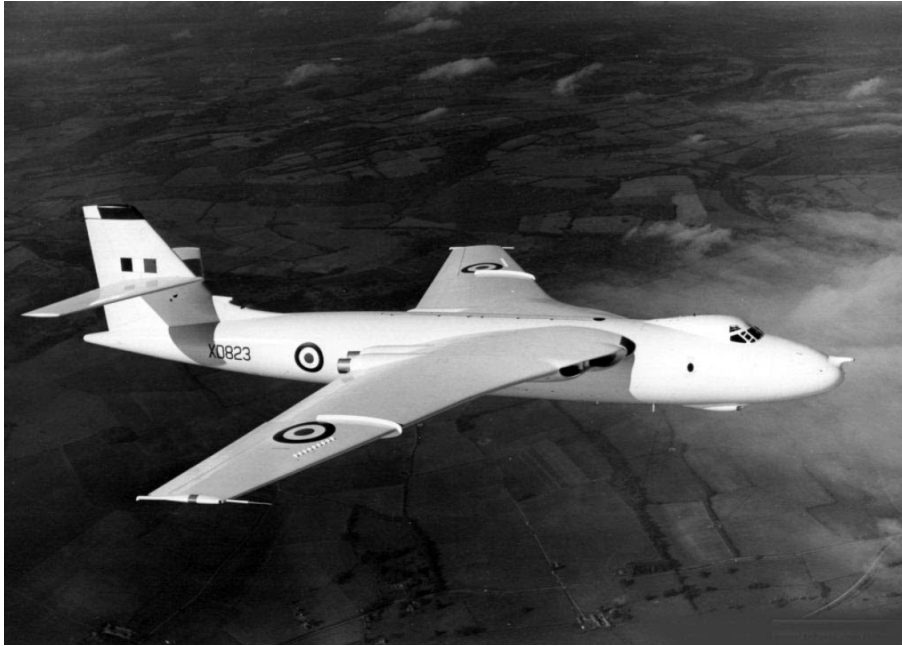
Figura 1.4 El Vickers Valiant usaba energía eléctrica para los controles de vuelo primario y otras funciones.
