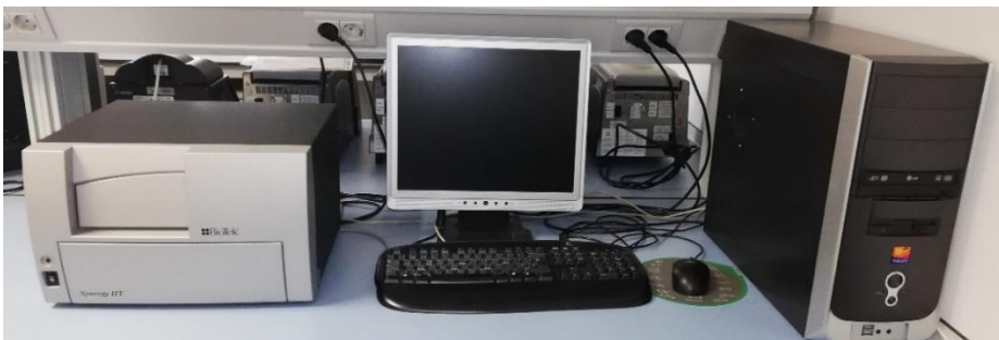
Figura 56: Espectrofotómetro con lector de microplacas para analizar la absorbancia de los materiales.
