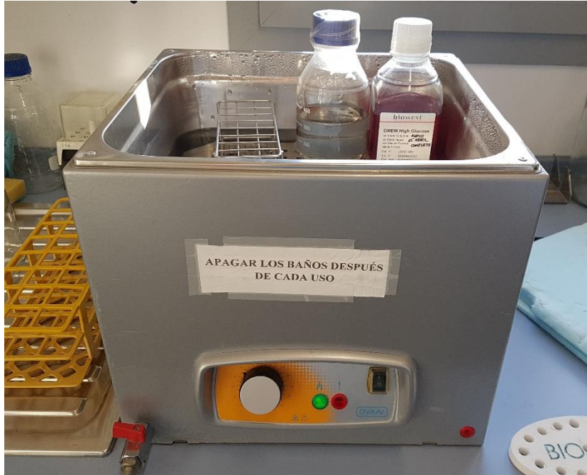
Figura 33: Baño térmico utilizado para atemperar a 37 °C.
