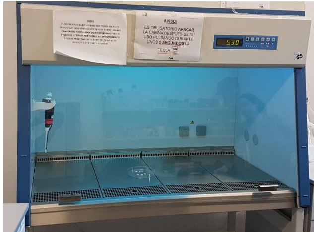
Figura 24: Imagen de la cabina de flujo laminar utilizada en la esterilización de los discos (Thermo Scientific™ Clase II MSC-Advantage™).
