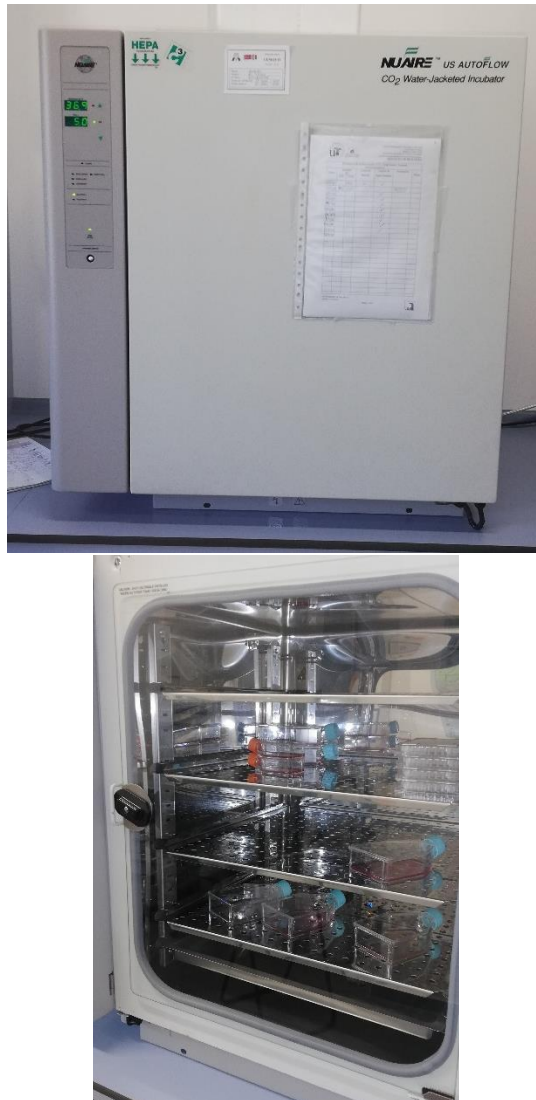
Figura 38: Imágenes del exterior e interior del incubador de CO2 Nuair US AutoFlow NU-4750-E.
