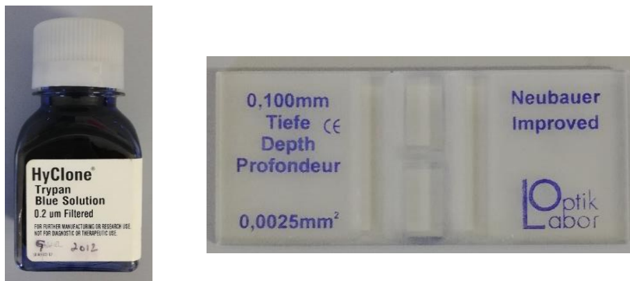
Figura 35: Solución de azul de tripán y cámara de Neubauer usados para medir la concentración celular.
