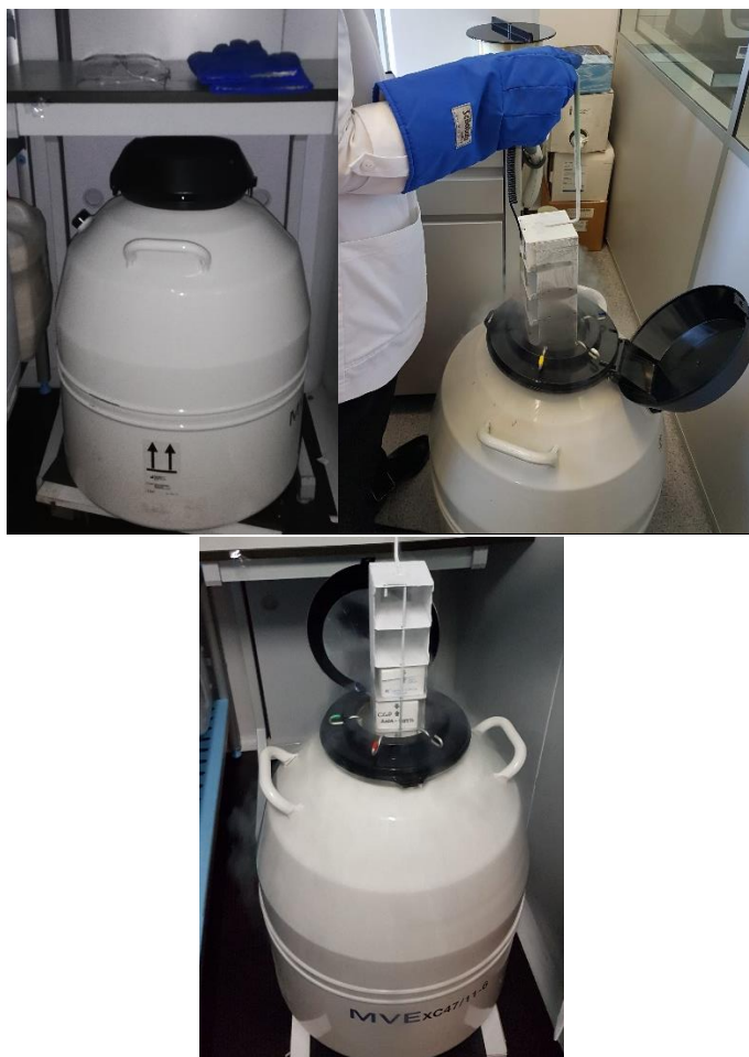
Figura 41: Secuencia fotográfica del procedimiento de recogida de los criotubos de células criopreservadas en el tanque de nitrógeno líquido.
