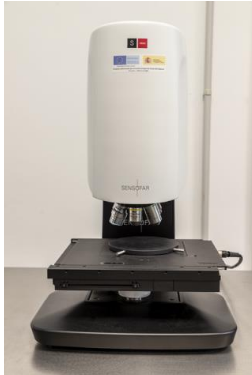
Figura 25: Perfilómetro óptico 3D Sensofar S Neox. Imagen obtenida a través del Centro de Investigación e Innovación de la Universidad de Sevilla [115].
