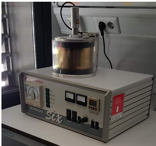
Figura 28: Imagen del metalizador Scancoat Six usado para aplicar la superficie de oro.
