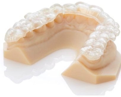
Ilustración 37. Funda dental impresa con material biocompatible con impresora Stratasys.
