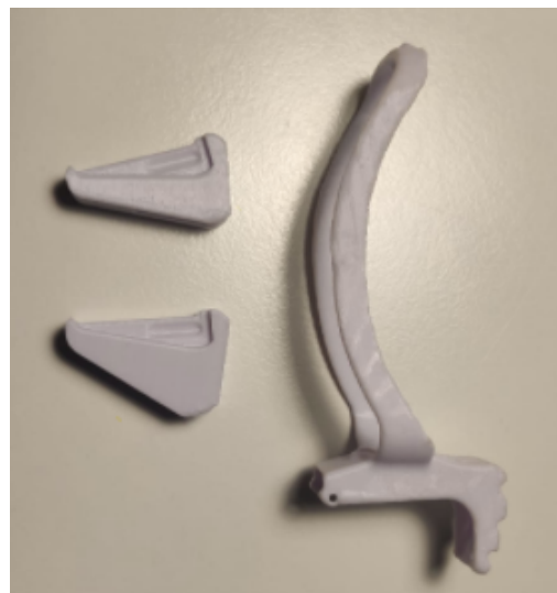
Ilustración 29. Guía de punción fabricada con PETG. De: FabLab y Urología HUVR
