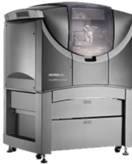
Ilustración 35. Impresora Stratasys Connex3 Objet260. Tecnología PolyJet
