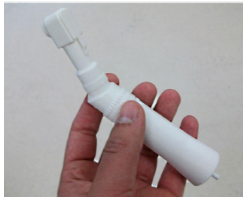
Ilustración 31. Implante mecánico impreso con Nylon. De: 3D printing techniques in medicine and surgery [238]
