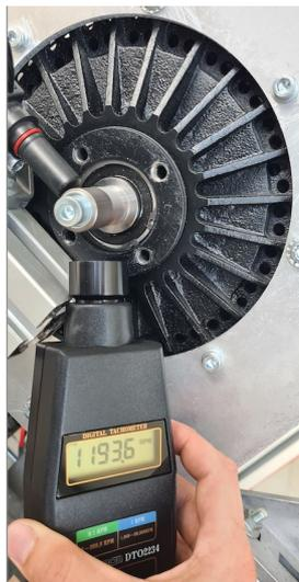
Figura 5.7 – Medição da velocidade rotacional do motor.
