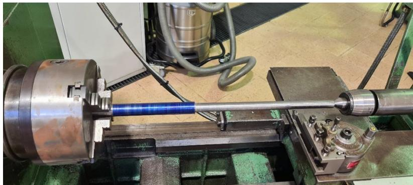
**Figura 3.17 – Veio do travão durante o processo de maquinação.**
