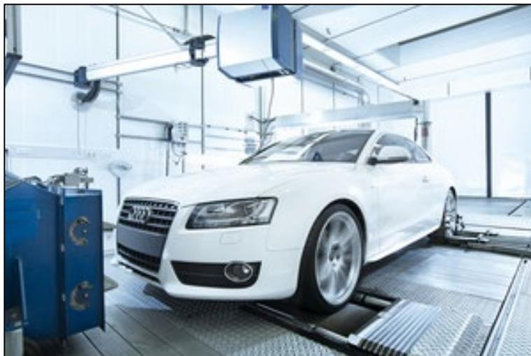
Figura 2.3 – Teste de um veículo em um dinamómetro de chassis [4].
