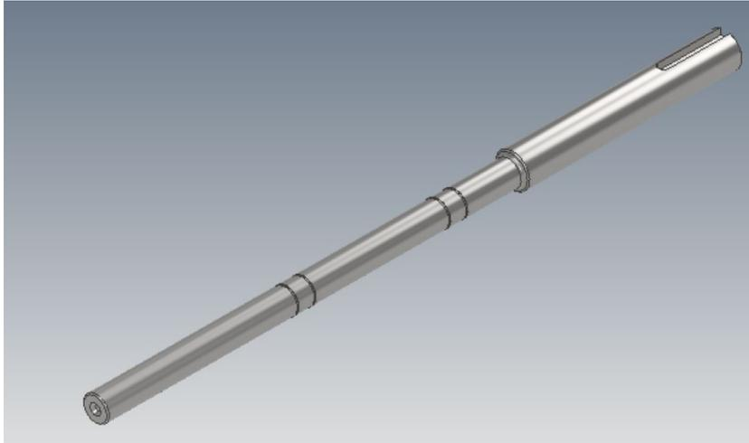
**Figura 3.15 – Veio do travão, com o diâmetro maior na extremidade direita.**
