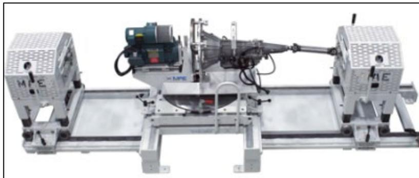
Figura 2.6 – Dinamômetro de transmissões [7].
