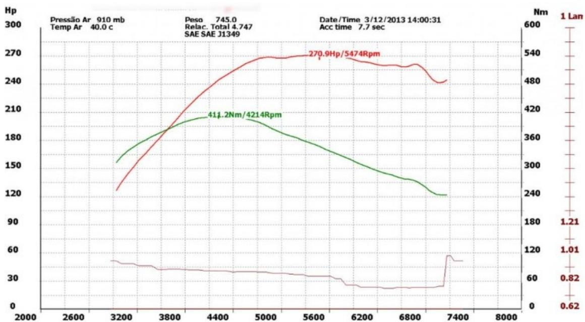
Figura 2.1 Curva características potência e binário de um motor a combustão. Adaptado de [3].
