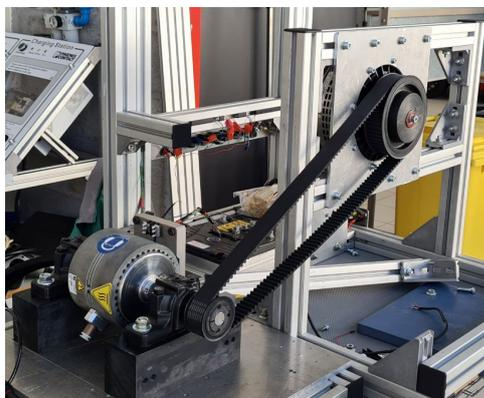
Figura 5.1 – Posicionamento do travão lateralmente ao motor.
