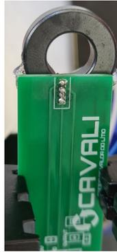
Figura 5.20 – Placa *Current Sensor* com detalhe a fixação do núcleo de ferrite.
