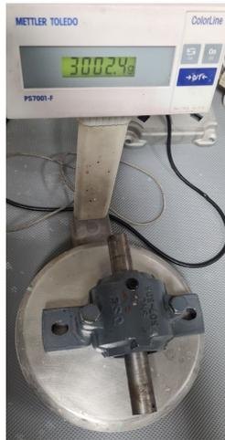
Figura 5.14 – Determinação da massa de um corpo de prova.
