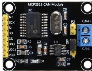
Figura 3.41 – Placa interface CAN, adaptado de [30].
