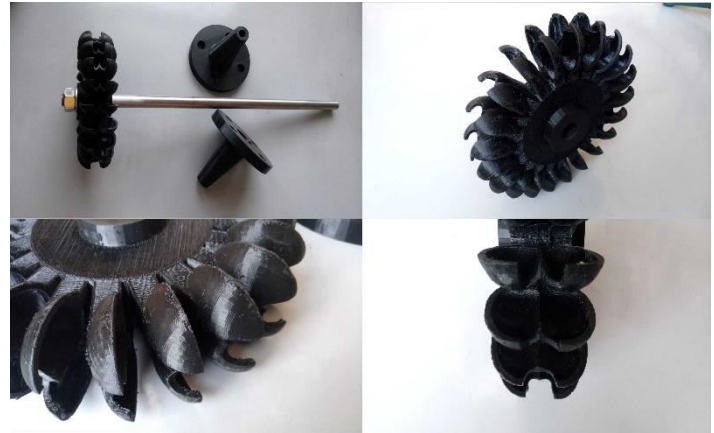
Slika 3.1. Izgled mlaznika i radnog kola nakon izrade na 3D štampaču
